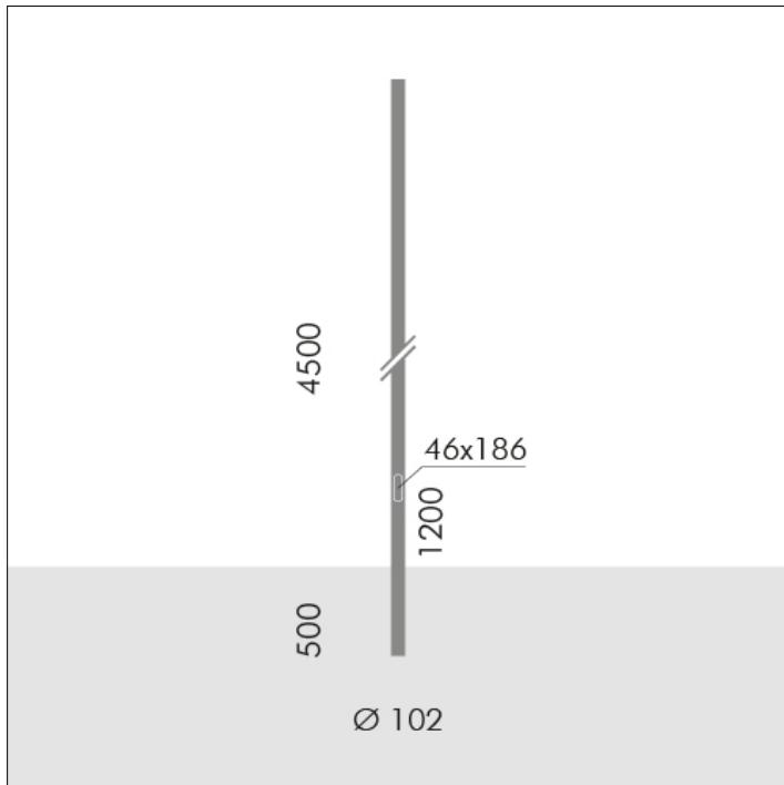
**S.2814****ZYLINDRISCHER MAST H 4,5m D 102mm,
